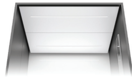
CL96 Acabamento: chapa pintada Branco Cashmere P63, aço escovado Astúria F Iluminação: barras LED Nota: disponível versão CL96FFL com alçapão e escada e versão CL96FF apenas com alçapão, ambas em conformidade com a norma EN81-72 anti-incêndio. Disponível versão CL96V em conformidade com a norma EN81-71 antivandalismo cat.1 em aço escovado Astúria F
